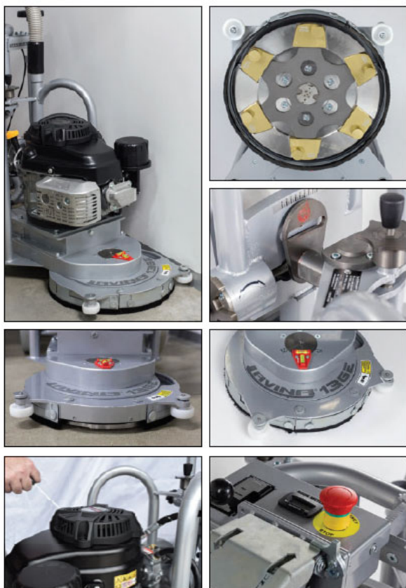
Алмазные инструменты Lavina с двумя четвертными круглыми сегментами PCD и двумя жертвенными стержнями
