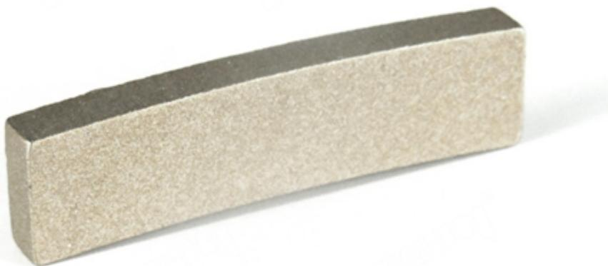
наш **Алмазные сегменты для гранитной резки** изготавливаются из высококачественной смеси алмазного порошка и металлического порошка, получаемой прессованием и спеканием, алмазный порошок и металлический порошок тесно сочетаются друг с другом, качество выше, а эффект лучше.
