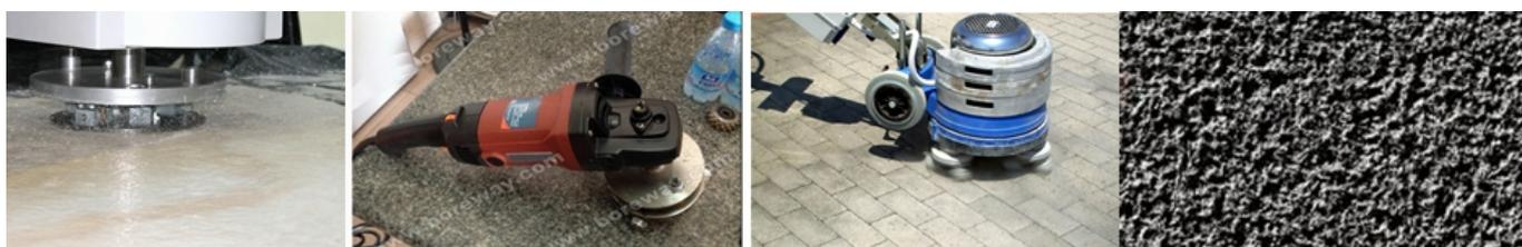
**Роликовые инструменты с твердосплавным наконечником 72S** может использоваться с напольными машинами или мощными шлифовальными машинами для забивания бетонных полов и поверхностей.
