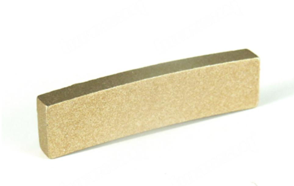
Nosso **Segmento de diamante de corte de borda de mármore** são feitos por pó de diamante de alta qualidade e mistura de pó de metal, produzido por prensagem e sinterização, pó de diamante e pó de metal se combinam estreitamente, a qualidade é maior e o efeito é melhor.
