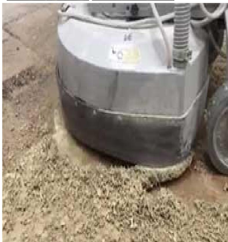
Ferramentas PCD Com barras de sacrifício ou botão Metal Bond, são projetadas para remover o revestimento sobre uma superfície igual a uma superfície com espátula e não danificam o concreto. As barras de sacrifício ou o botão de metal atuam como estabilizador e guia de profundidade e reduzem a aferição do piso causada pelos agressivos segmentos de pcd. Essas ferramentas são adequadas para a remoção de:
