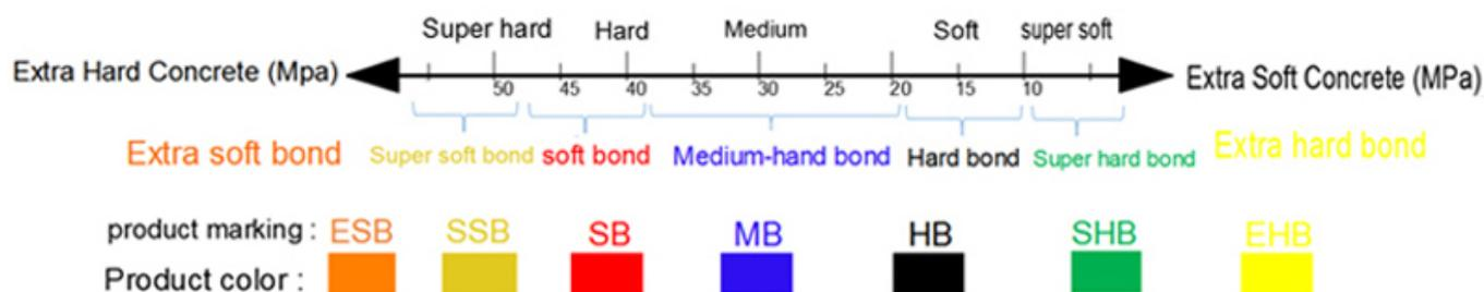
**Husqvarna sapata de barra de diamante de 2 segmentos para moagem de concreto e fornecedores de Terrazzo** desenvolveu uma ampla gama de ferramentas diamantadas com liga de metal para atingir a capacidade máxima a um custo mínimo e para se adequar à maioria dos tipos de piso. A combinação de vários pisos e colagem é tão segue.
