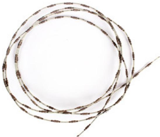
**O fio soldado 2.2mm do corte do diamante considerou cortando a cerâmica de pedra macia**
