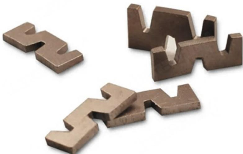
Nella stessa condizione di legame del segmento, breve lunghezza significa meno resistenza, **Segmento diamantato taglio bordo in granito** è utile per ridurre la resistenza al taglio delle pietre, quindi aiuta a migliorare la velocità di taglio. Con il miglioramento della velocità di taglio, questo design offre un taglio molto regolare.
