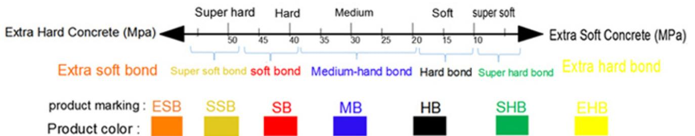
**Pattini per barra abrasiva diamantata a 2 segmenti Husqvarna per fornitori di calcestruzzo e terrazzo** ha sviluppato una gamma molto ampia di utensili diamantati a legante metallico per ottenere la massima capacità al minimo costo e per adattarsi alla maggior parte dei tipi di pavimento. é come segue.
