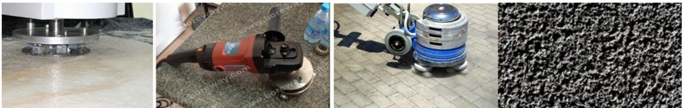
**Rullo del martello del cespuglio della lega di calcestruzzo** Può essere regolato con il nostro martello Bush attraverso la regolazione dell'elasticità a molla sul martello della boscaglia, o attraverso la pressione della rettificatrice manuale.
