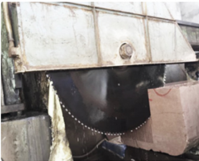
disco diamantato solo per uso bagnato
