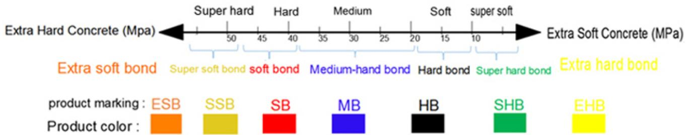
Soft Bond - La poudre métallique dans le segment fritté s'use rapidement, libérant des cristaux de diamant ternes, exposant de nouveaux cristaux abrasifs à couper efficacement. Idéal pour les surfaces dures.
