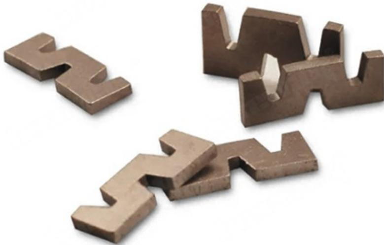
Sous la même condition de liaison de segment, la longueur courte signifie moins de résistance, **Segment de diamant de coupe de bord de granit** est bon pour réduire la résistance de coupe des pierres, donc il aide à améliorer la vitesse de coupe. Avec l'amélioration de la vitesse de coupe, cette conception donne une coupe très lisse.
