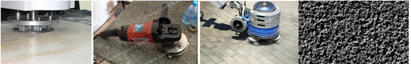
**Outils de rouleau de marteau de Bush de pointe de carbure 72S** peut être utilisé avec des machines à plancher ou des meuleuses puissantes pour le bouchardage des sols et des surfaces en béton.
