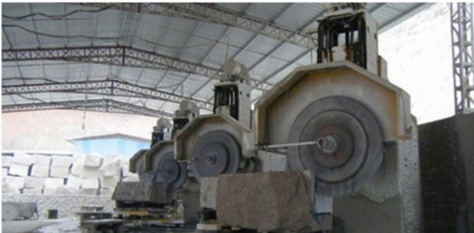
1. Si le matériau est dur, la liaison des segments de diamant doit être plus douce.
