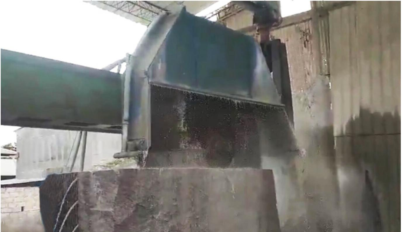
1. Si le matériau est dur, la liaison des segments de diamant doit être plus douce.
