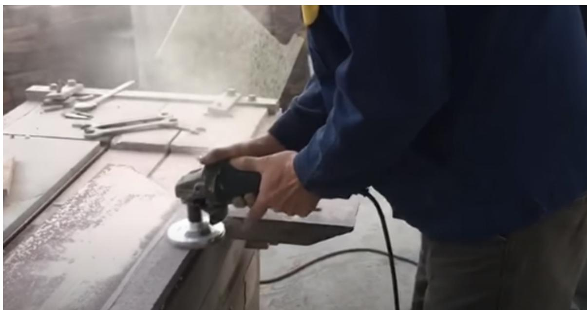
Meule de coupe à ondulation arrière en aluminium diamant Pour meuleuse d'angle directement ou installée sur la meuleuse d'angle avec une rallonge
