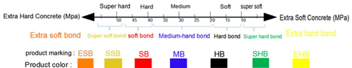
**Enlace suave:** el polvo metálico en el segmento sinterizado se desgasta y libera rápidamente los cristales de diamante opacos que exponen nuevos cristales abrasivos para cortar de manera eficiente. Se utiliza mejor en superficies duras.
