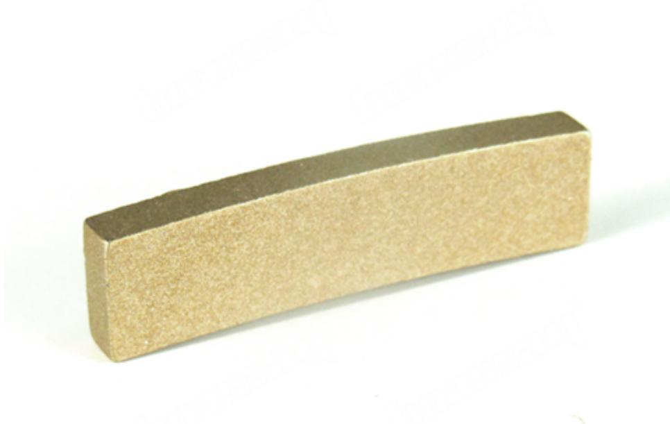
Nuestro **Segmento de diamante de corte de borde de mármol** están hechos de polvo de diamante de alta calidad y mezcla de polvo de metal, producidos por prensado y sinterización, el polvo de diamante y el polvo de metal se combinan estrechamente, la calidad es mayor y el efecto es mejor.
