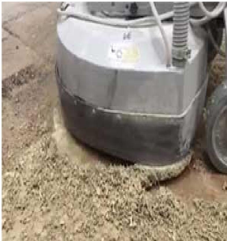
Las herramientas PCD con barras de sacrificio o botón de enlace de metal están diseñadas para eliminar el recubrimiento sobre una superficie igual a una superficie alisada y no dañarán el concreto. Las barras de sacrificio o el botón de metal actúan como estabilizador y guía de profundidad, y reducen la medición del piso causada por los agresivos segmentos de pcd. Estas herramientas son adecuadas para eliminar:
