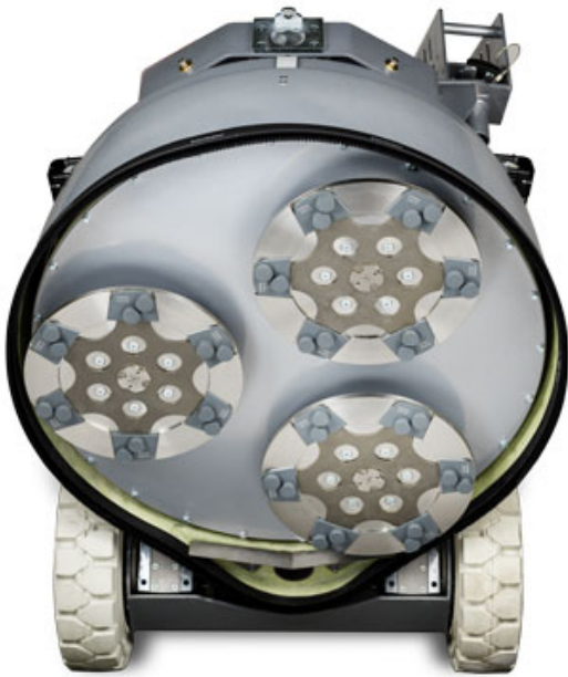
Herramienta Lavina Diamond con segmentos PCD de doble trimestre y un segmento de barra
