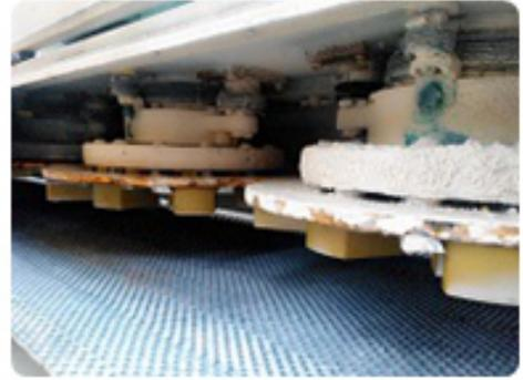
**Bloque de metal de diamante piedra frankfurt** Está diseñado para la calibración de mármol y la molienda áspera.
