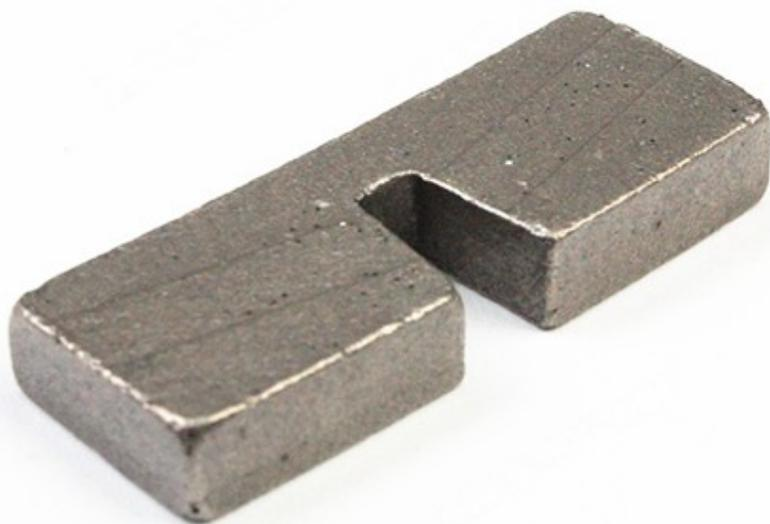
Bajo la misma condición de enlace del segmento, la longitud corta significa menos resistencia, **Segmento de corte de borde de diamante para granito** Es bueno para reducir la resistencia al corte de las piedras, por lo tanto, ayuda a mejorar la velocidad de corte. Con la mejora de la velocidad de corte, este diseño proporciona un corte muy suave.
