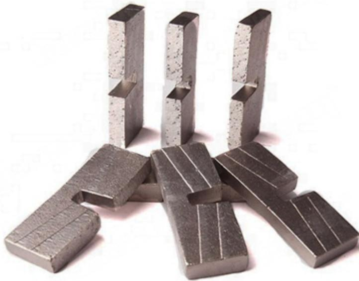
Bajo la misma condición de enlace del segmento, la longitud corta significa menos resistencia, **Segmento de diamante con muesca de corte de mármol de alta eficiencia** Es bueno para reducir la resistencia al corte de las piedras, por lo tanto, ayuda a mejorar la velocidad de corte. Con la mejora de la velocidad de corte, este diseño proporciona un corte muy suave.
