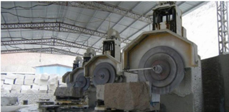
1. Si el material es duro, la unión de los segmentos de diamante debería ser más suave. Porque los diamantes se volverán romos al cortar material duro. Un enlace más suave puede ser desgastado con los diamantes romos más rápido, luego haga que los nuevos diamantes debajo se espongan más fácilmente para participar en el corte
