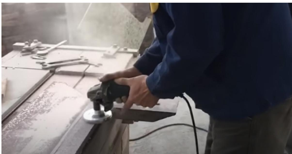
Rueda de copa ondulada trasera de aluminio con diamante Para amoladora angular directamente o instalada en la amoladora angular con un poste de extensión
