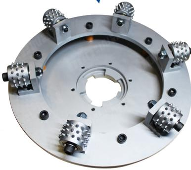
**Herramienta de fabricación de superficie de placa de martillo de 17 pulgadas 6T \* 45S** fabrica superficies antideslizantes de mármol, granito y piedras naturales. Elimina colas, pinturas y resinas epoxi. Rompe resinas espesas difícilmente removibles con otro tipo de herramientas. Crea el "efecto de cara expuesta" en paneles prefabricados. Abujarda todo tipo de superficies.
