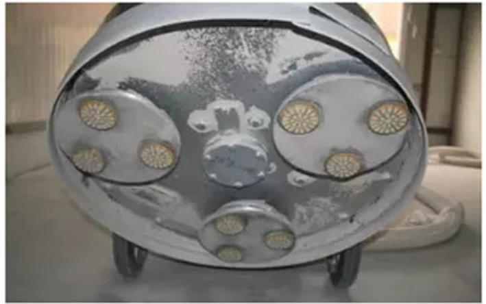
**Einzelne Rhombus-Segment-Betonschleifpads**, HochQualitätsdiamantkamm mit ausgezeichneter Bindung, das spezielles Design für sehr aggressive, leistungsstarke und langlebige Diamantschleifwerkzeuge.
