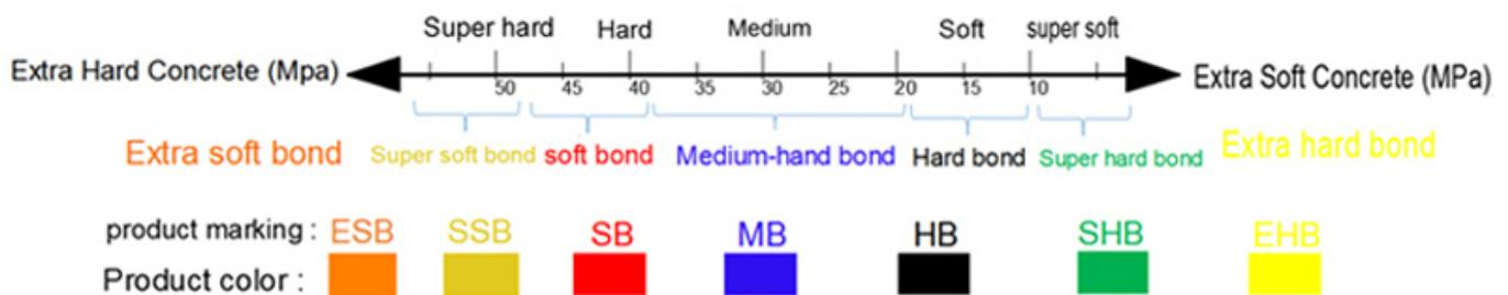
Öval Segment Husqvarna Schleifscheibehat ein sehr breites Spektrum an Metall-Bond-Diamantwerkzeugen entwickelt, um maximale Kapazität zu minimalen Kosten zu erreichen und die meisten Arten von Böden anzupassen. Das Anpassen verschiedener Böden und Anleihe ist als folgt
