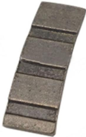
Unser **Granit-Diamant-Segment zum Schneiden von Kanten** werden durch hochwertige Diamantpulver- und Metallpulvermischung hergestellt, hergestellt durch Pressen und Sintern, Diamantpulver und Metallpulver verbinden sich eng, die Qualität ist höher und die Wirkung ist besser.
