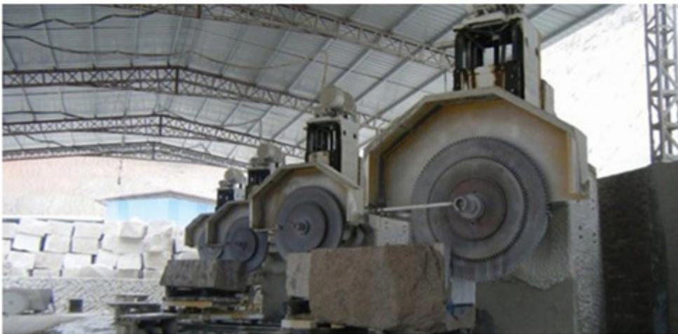
1. Wenn das Material hart ist, sollte die Bindung der Diamantsegmente weicher sein.
