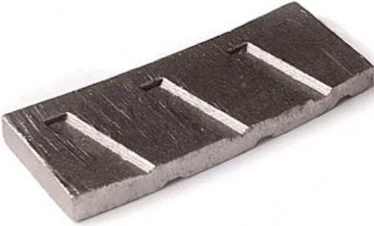
لنا الماس فتحة فتحة شريحة لقطع الجرانيت مصنوعة من مسحوق الماس عالي الجودة وخليط مسحوق معدني ، التي تنتجها الضغط وتلبد ، مسحوق الماس ومسحوق المعادن تتحد بشكل وثيق ، والجودة أعلى وتأثير أفضل.
