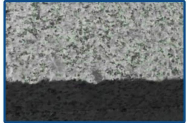
1. إذا كانت المادة صلبة ، يجب أن تكون رابطة قطاعات الماس أكثر ليونة. لأن الماس سوف تصبح حادة عند قطع المواد الصلبة. السندات ليونة يمكن أن يكون تهدأ مع الماس غير حادة بشكل أسرع ، ثم جعل الماس الجديد تحتها يتعرض بسهولة أكبر للمشاركة في القطع
