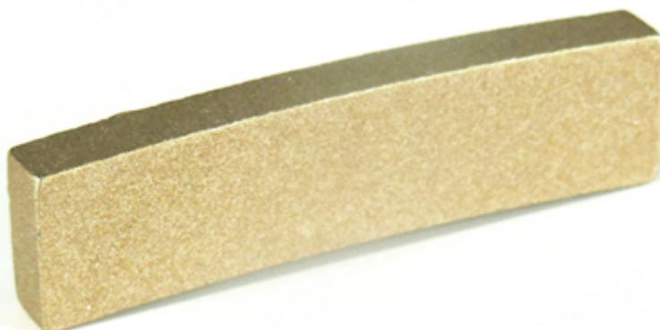
Nuestra **Segmento de diamante de corte de borde de mármol** están hechos de polvo de diamante de alta calidad y una mezcla de polvo de metal, producidos por prensado y sinterización, el polvo de diamante y el polvo de metal se combinan estrechamente, la calidad es mayor y el efecto es mejor.
